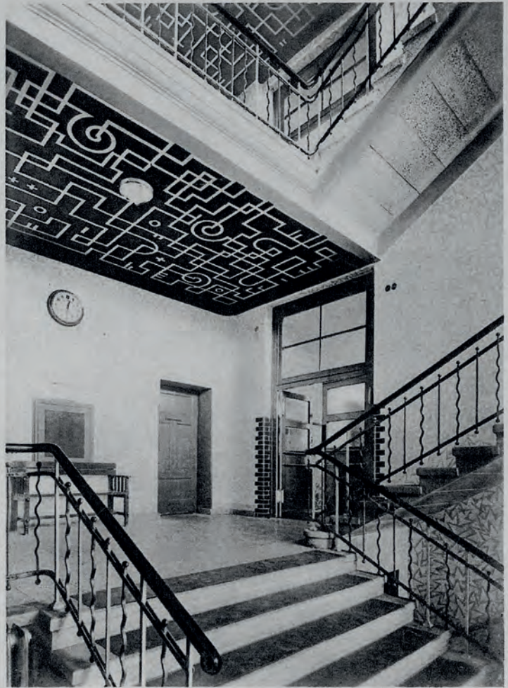
Das alte Treppenhaus im Hans Böhm-Gebäude ist durch Farbstellung bedeutend mehr als bisher gegliedert. Edelgraue Wände in Ölfarbe, mittels willkürlich angeordneten Zinkschablonen gemustert, und schiefergraue Decken mit Aluminiumbronze kontrastieren mit den bunten Türen im jeweiligen Farbton des betreffenden Geschosses. Maler Erich Wolf, Berlin.
